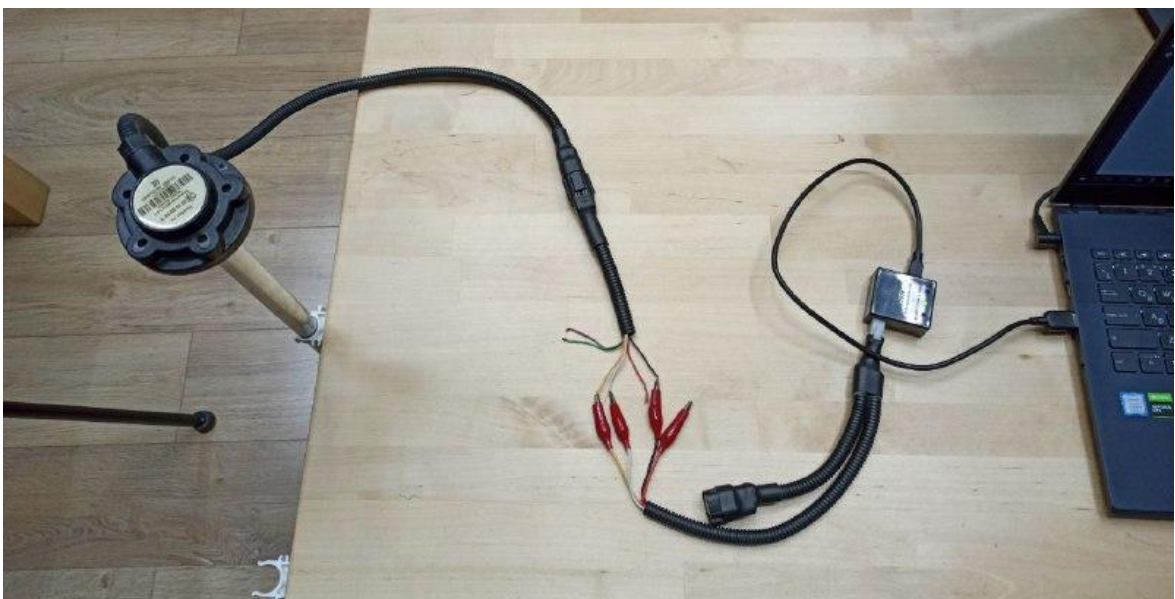
Рис. 5 Подключены оранжевый, белый и черный провод. Красный провод питания ОТКЛЮЧЕН
